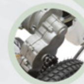
CAIXA DE TRANSMISSÃO
